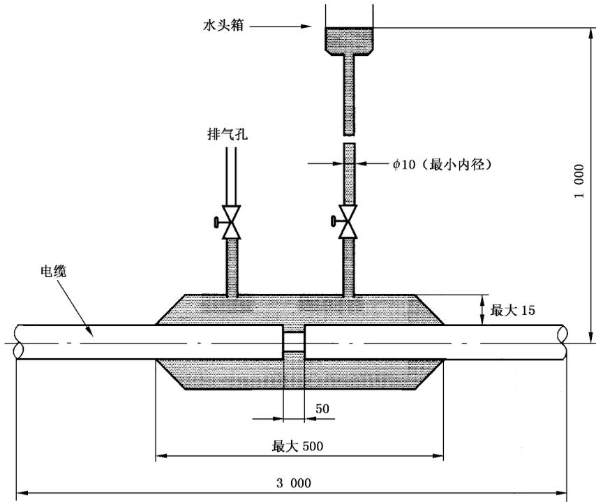
图 F.1 纵向透水试验示意图
