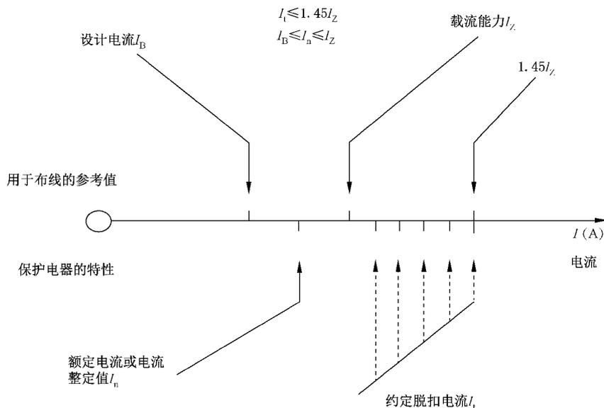
图 6 用于熔断体选择的电流
