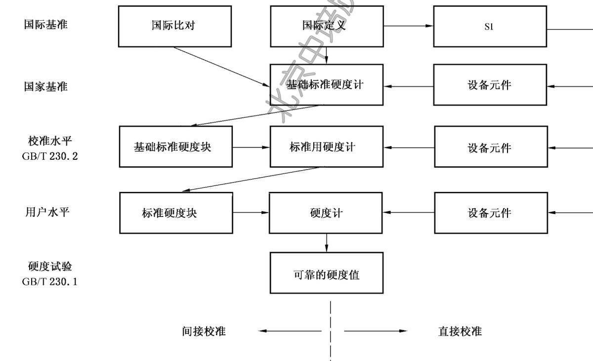
注: 图 G.1 的左侧表示通过校准层级(即国家,校准和用户)中每个级别的单个校准链进行的溯源性路径,包括标准块的校准和洛氏硬度试验机的间接检定。基础标准硬度计(国家级)用于校准基础标准硬度块,基础标准硬度块用于校准校准用硬度计(校准级),校准用硬度计用于校准标准硬度块,标准硬度块用于校准硬度计(用户级)。
