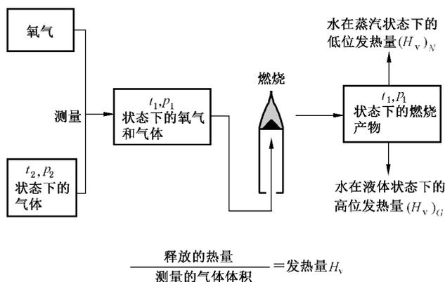
图 1 计量和燃烧参比条件下的体积发热量
