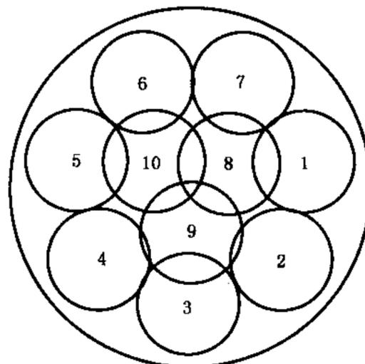
图 2 第二层捣压位置示意图
