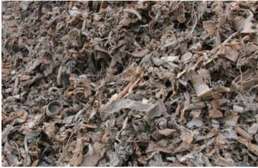
图 B.7 破碎型再生钢铁原料 SRS401/402
