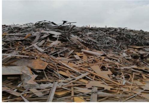
图 B.2 重型再生钢铁原料 HRS102
