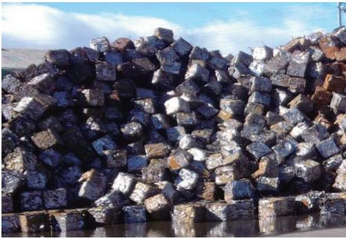
图 B.9 包块型再生钢铁原料 BRS501
