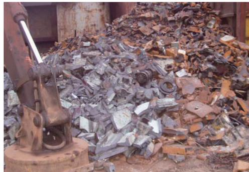
图 B.12 铸铁再生钢铁原料 CRS701
