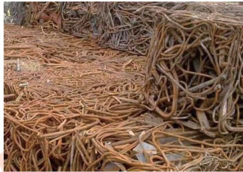
图 B.10 包块型再生钢铁原料 BRS502
