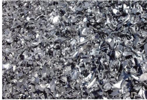
图 B.8 破碎型再生钢铁原料 SRS403
