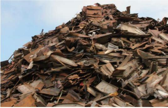
图 B.1 重型再生钢铁原料 HRS101
